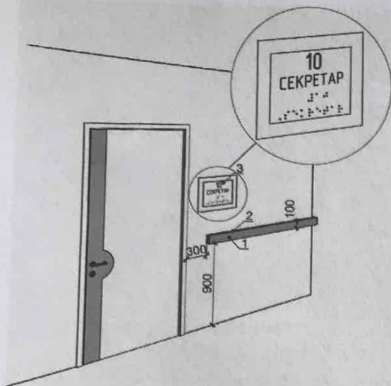
Рис. 9. Приклад розміщення тактильних інформаційних покажчиків приміщень: 1 - інформаційна направляюча; 2 - тактильна інформаційна позначка; 3 - інформаційна тактильна табличка, що дублює текстову інформацію у тактильному вигляді плоскодрукованого тексту та шрифтом Брайля
