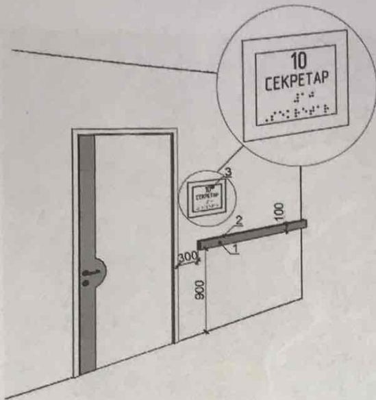
Рис. 10. Приклад розміщення тактильних інформаційних покажчиків приміщень: 1 - інформаційна направляюча; 2 - тактильна інформаційна позначка; 3 - інформаційна тактильна табличка, що дублює текстову інформацію у тактильному вигляді плоскодрукованого тексту та шрифтом Брайля
