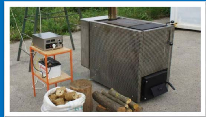
КОГЕНЕРАЦІЙНА ТЕРМОЕЛЕКТРИЧНА УСТАНОВКА ДЛЯ ЗСУ
